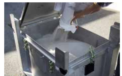
Caja de extinción que protege la batería en llamas por todos lados con EXTOVER®. Esto evita que el fuego se propague.
