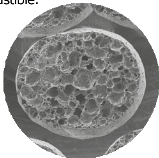
Gránulos multicelulares expandidos con una estructura de poro parcialmente cerrado.
