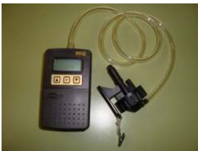
Bomba conectada a ciclón equipado con filtro de PVC
