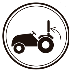
A ROPS abatible debe estar despregada.
