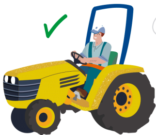
Tractor con ROPS e cinto de seguridade abrochado
