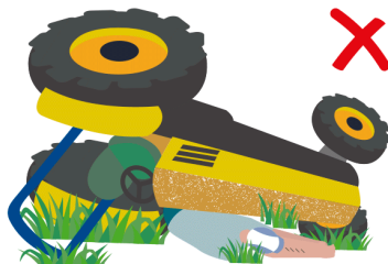
O condutor sae lanzado fóra da zona de seguridade e pode resultar esmagado polo tractor
