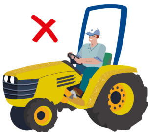
Tractor con ROPS pero sen cinto de seguridade
