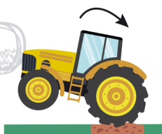
Envorco cara a atrás debido a un atranco.
