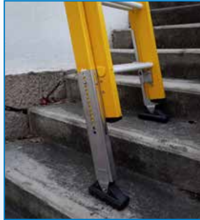
Se o solo é inclinado ou con desniveis verifica que dispón de patas regulables ou outros sistemas que aseguren a súa nivelación e estabilidade. Nunca uses elementos improvisados (bloques, táboas...) para compensar os desniveis da base de apoio.
