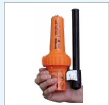
Transpondedores de radar
