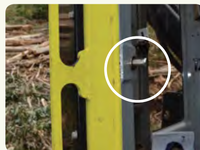
Interruptor de seguridade para a porta
