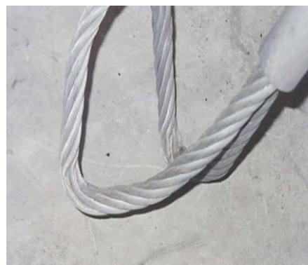
Exemplo duna eslinga de cable defectuosa
