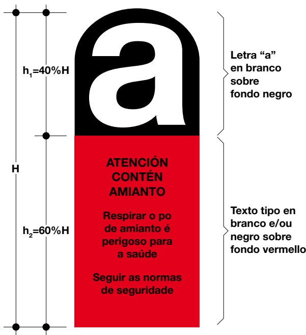
Etiqueta que identifica produtos ou envases con amianto segundo o RD 1406/1989
