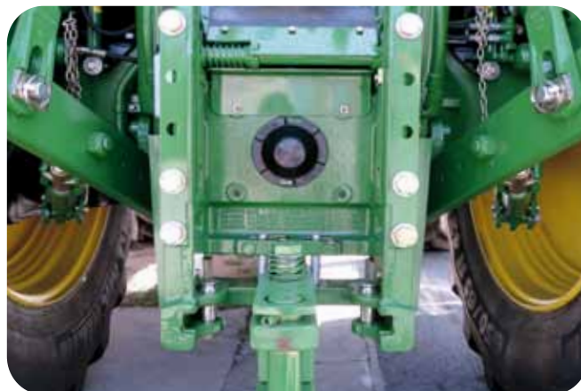
PROTECTOR SUPLEMENTARIO , non rotativo, para cubrir completamente a toma de forza cando esta non se utilice (debe entregarse co tractor)
