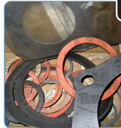
Junta de cartón- amianto
