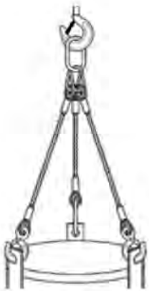
Figura P9.- Los puntos de enganche al equipo de elevación y de prensión de la carga aseguran un reparto equilibrado de la carga
