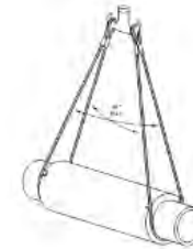
Figura P2.- Carga simétrica con eslingas en cesto (carga abrazada)
