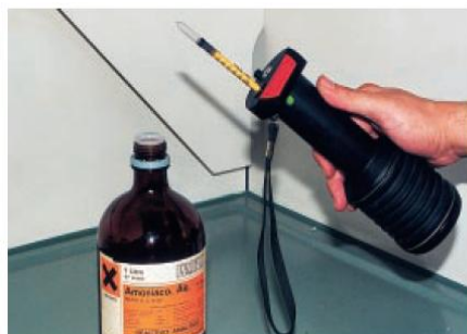
Medición con tubo detector específico cuantitativo para amoníaco
