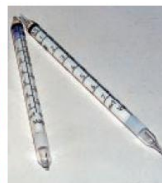
Medición puntual con tubo detector colorimétrico específico para \text{CO}_2
