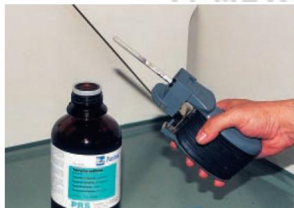
Medición con tubo detector genérico cualitativo (Politest, Qualitest, ...)
