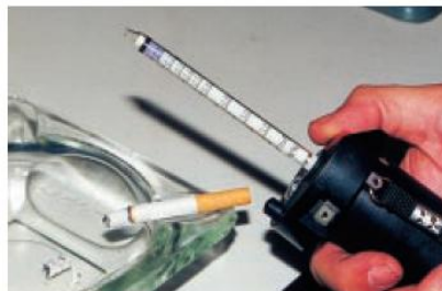
Medición puntual con tubo detector colorimétrico específico para \text{CO}_2
