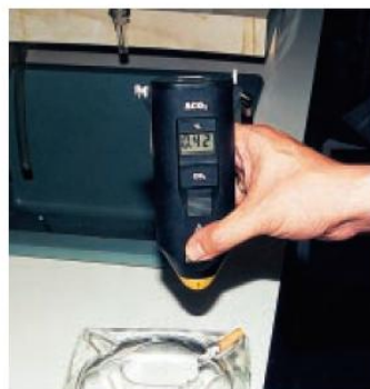
Medición con detector continuo de \text{CO}_2 , con alarma óptica y acústica
