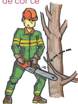
E Exceso de percorrido de corte
